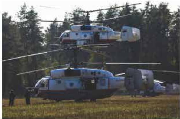
Вертолет Ка-32А с системой горизонтального, вертикального и бокового пожаротушения, 2014 г.
