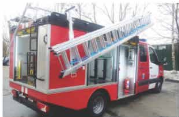
Автомобиль быстрого реагирования с установкой «Кобра»
